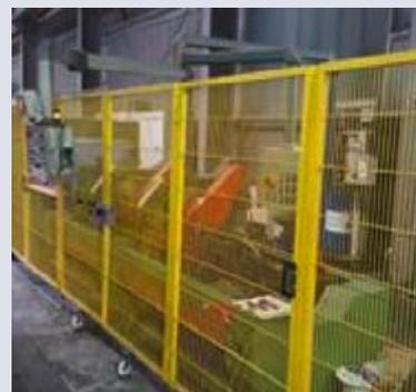
Der neue Sicherheitskäfig an einer Verseilmaschine.
